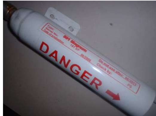
Fig. 2: Cartouche pyrotechnique du système parachute BRS
