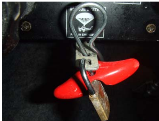
Fig. 3: Cadenas installé sur la commande du parachute de secours
