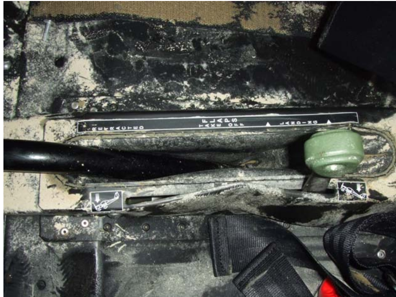
Fig. 7: Position du levier du compensateur de profondeur ( trim )
