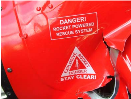
Fig. 1: Identification du BRS sur la tôle de recouvrement de l'avant du tableau de bord
